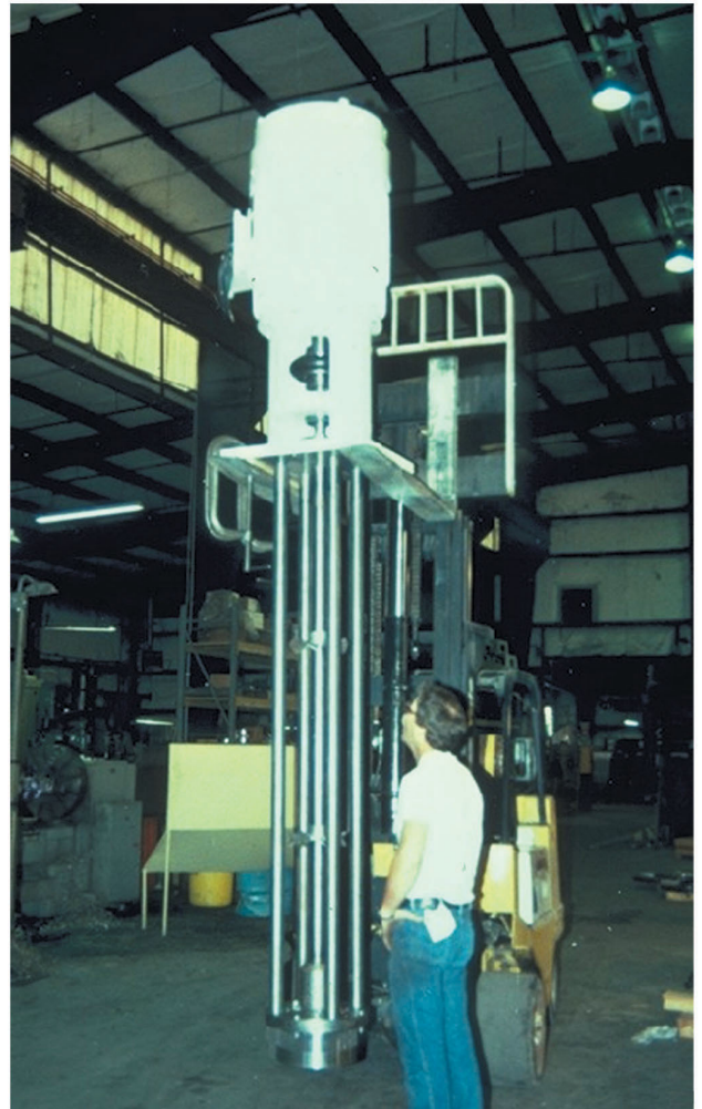
SM-275高剪切均質乳化機:55KW電機功率用于大型容器的批量生產。
